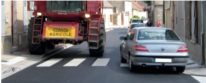
Des voies trop étroites augmentent le risque de collision lors du croisement des engins agricoles avec d'autres usagers de la route
