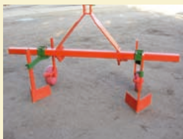
Système de pioches à atteler à l'avant du tracteur pour détruire les micro-barrages au moment de la récolte
