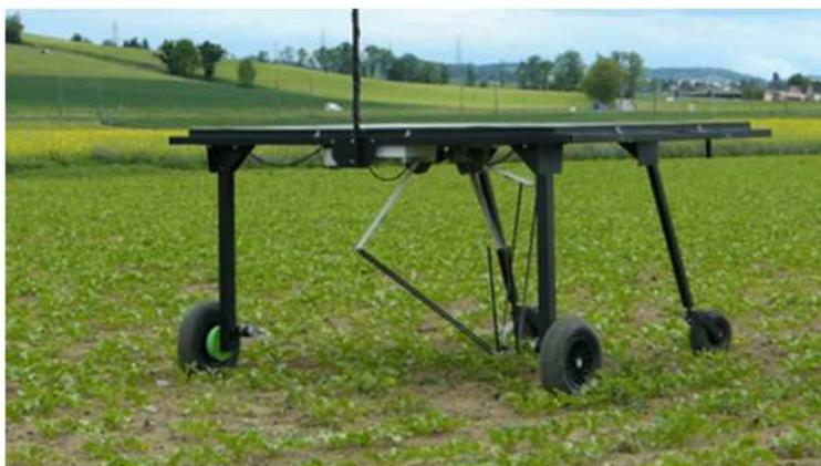
Equippé de GPS et de panneaux photovoltaïques, le robot peut travailler en autonomie pendant 10 heures traiter de 2 à 10 hectares par jour et en divisant par 2 l'utilisation de produits phytos.
