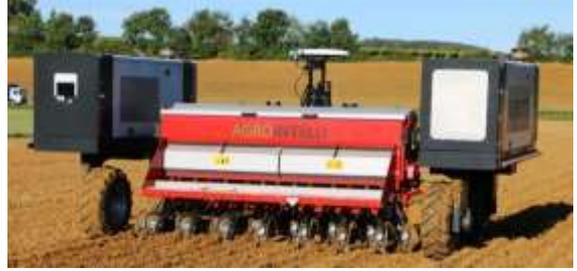
Ex : AgroIntelli - Le « Robotti » est conçu pour utiliser du matériel existant grâce à son relevage 3 points. La version 150 HD est équipée de 2 moteurs de 75 ch, montés latéralement sur chaque train de roues
