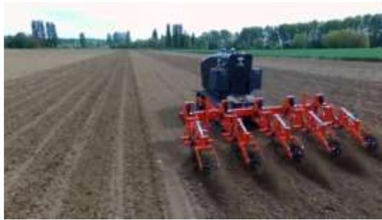
Ex : Dans le cadre du projet Centéol (2019), Kuhn & Agreenculture ont géré 50 ha de maïs avec 3 robots à chenille (30 ch) → travail du sol, semis, désherbage mécanique et chimique.
