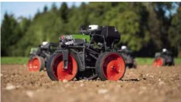
Ex : Le robot de semis Xaver de Fendt (2,6 kWh, 200 kg, 3 roues) sème sur un rang et positionne les graines au cm. Une flotte de 6 robots sème 3 ha/h. Les robots sont amenés au champ avec un véhicule équipé de bornes de recharge (1,5 h d'autonomie). Le fonctionnement est dépendant de la couverture 5G.
