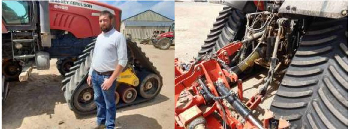
*Les chenilles arrière nécessitent d'utiliser des rallonges pour les bras de relevage et le 3<sup>e</sup> point.*
