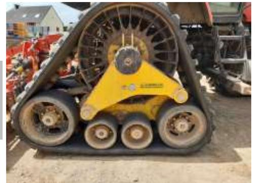
*Compte tenu du désaxage de la chenille vis-à-vis de l'axe du pont, la répartition de la charge est différente entre les parties avant et arrière.*
