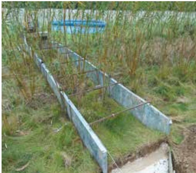
Dispositif de mesure de ruissellement de l'AREAS sur une bande de saules
