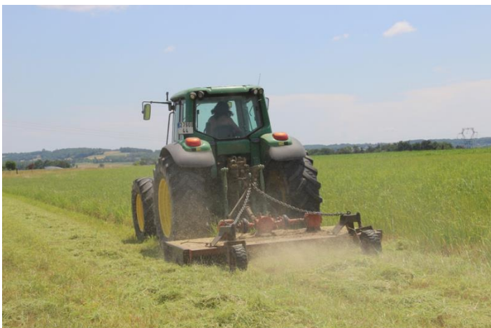
Photo 4 : Broyage du switchgrass avec un broyeur à axe vertical - juin 2015 - Montans (81) – Arvalis Institut du Végétal
