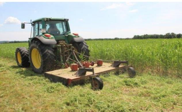
**Photo 4 :** Broyage du miscanthus avec un broyeur à axe vertical
