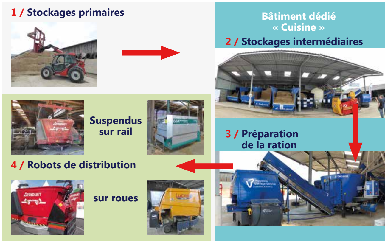
Figure 5.1 : Schéma de principe du mode de fonctionnement de l'automatisation de l'alimentation
