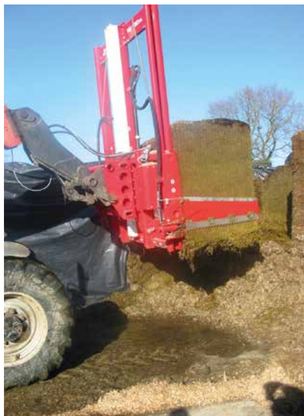
Photo 8.5 : Désileuse cube en action avec de l'ensilage d'herbe
