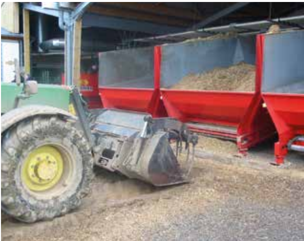
Photo 8.7 : Désilage avec godet pour alimenter les stockeurs (vrac)
