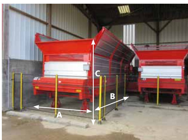
Photo 5.6 : Exemple de stockeurs Jeantil qui se chargent par le haut
