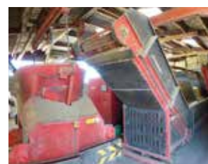
Photo 5.14 : Automate Trioliet qui effectue le mélange et la distribution
