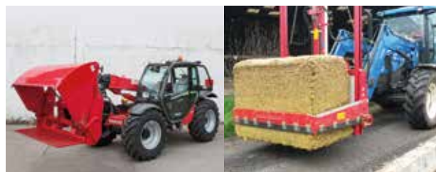
Photo 5.2 : Approvisionnement des fourrages grossiers : à gauche Godet à mâchoires tranchantes, à droite Dessil'cube fixé sur le chargeur du tracteur source: Photo Redrock
