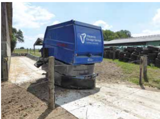
Photo 7.7 : Cet automate sur roues peut gravir des pentes de 5%
