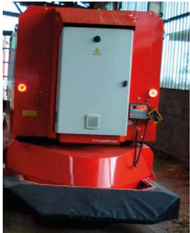
Photo 14.11 : Pare-chocs frontaux/barre anticollision (arrêtent la machine au premier contact)
