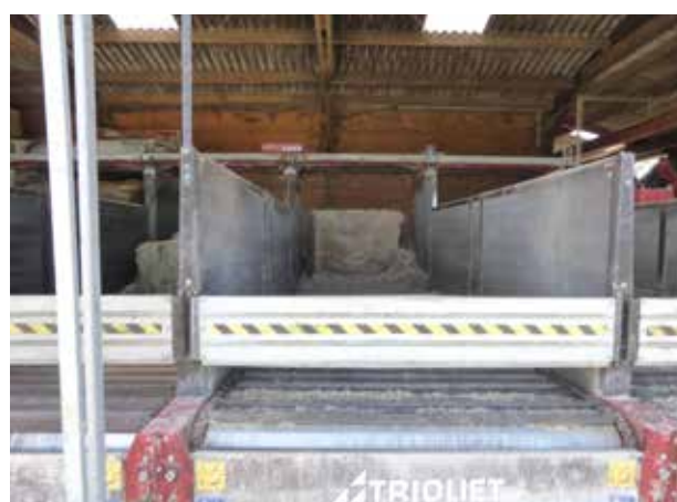
Photo 5.5 : Tables jointives de la marque Trioliet pour une plus grande compacité
