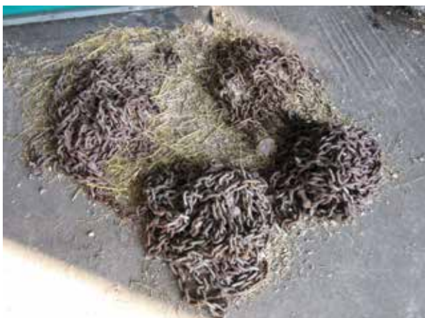
Photos 13.2 et 13.3 : Changement des chaînes et des barrettes d'entraînement de tables de stockage.
