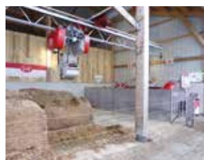
Photo 5.12 : Griffe de chez Lely qui alimente l'automate en attente dans la cuisine
