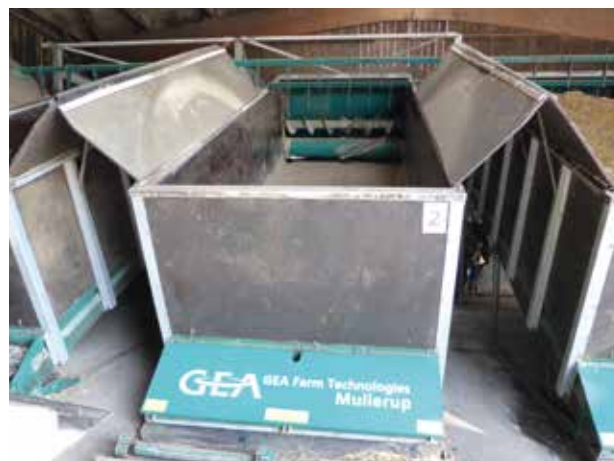
Photo 13.4 : Panneaux composite bois en parois
