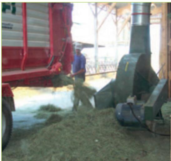
Alimentation de l'aéro-engrangeur au déchargement de l'autochargeuse.
