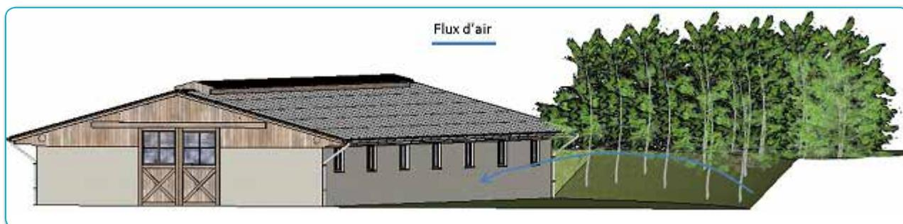
Sur ce schéma nous pouvons observer un effet vent qui vient souvent contrarier la ventilation dans les bâtiments. Nous retrouvons souvent ce type d'obstacle sur le terrain sous forme de talus ou de haies.
