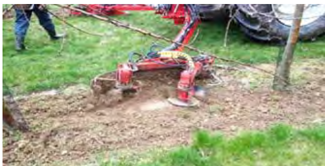
De nouveaux outils permettent le désherbage mécanique sur le rang
