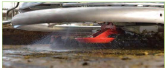
Photo 29 : Robot de raclage avec pulvérisation à l'avant.
