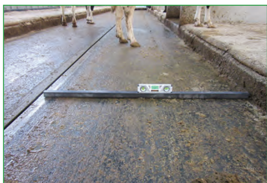
Photo 11 : Mesure de la pente transversale avec un niveau électronique posé sur une barre métallique
