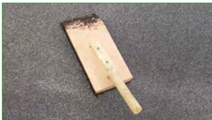
Photo 5 : Palette à asphalte en bois (longueur et largeur variable selon les préférences de l'applicateur)
