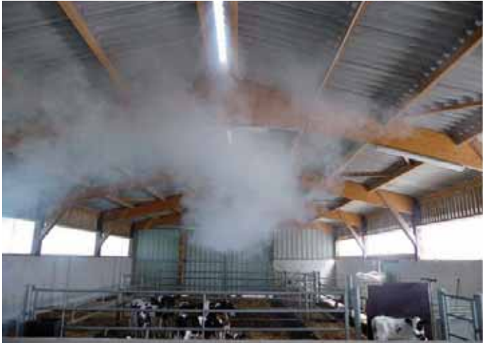
Observation du circuit d'air par fumigène
