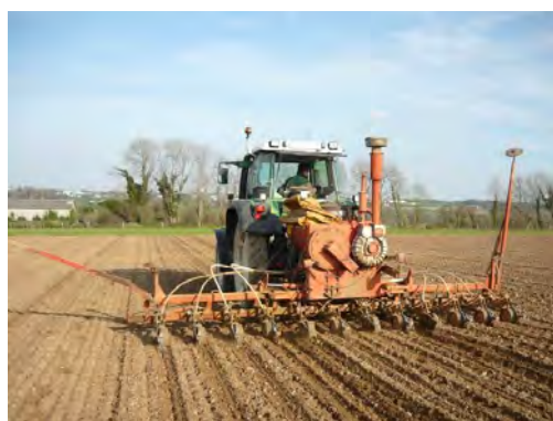
La féverole pure est semée au semoir pneumatique avec un inter-rang de 45 cm
