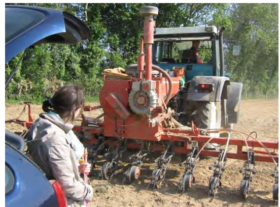
Particularité du semoir de l'exploitation : l'écartement entre les rangs est de 45 cm, au lieu de 75 cm souvent observé.
