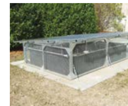
Héliosec sur dalle béton
