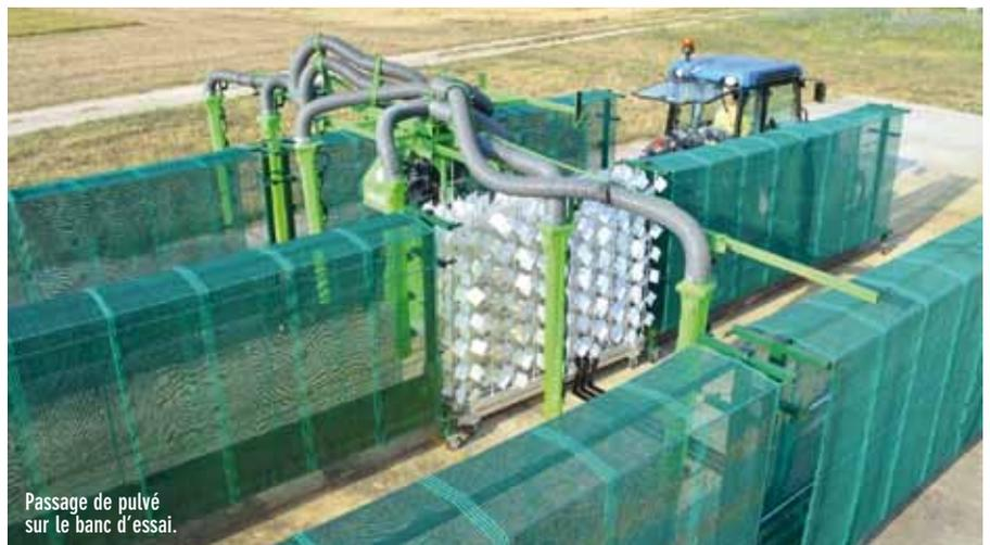
Passage de pulvé sur le banc d'essai.
