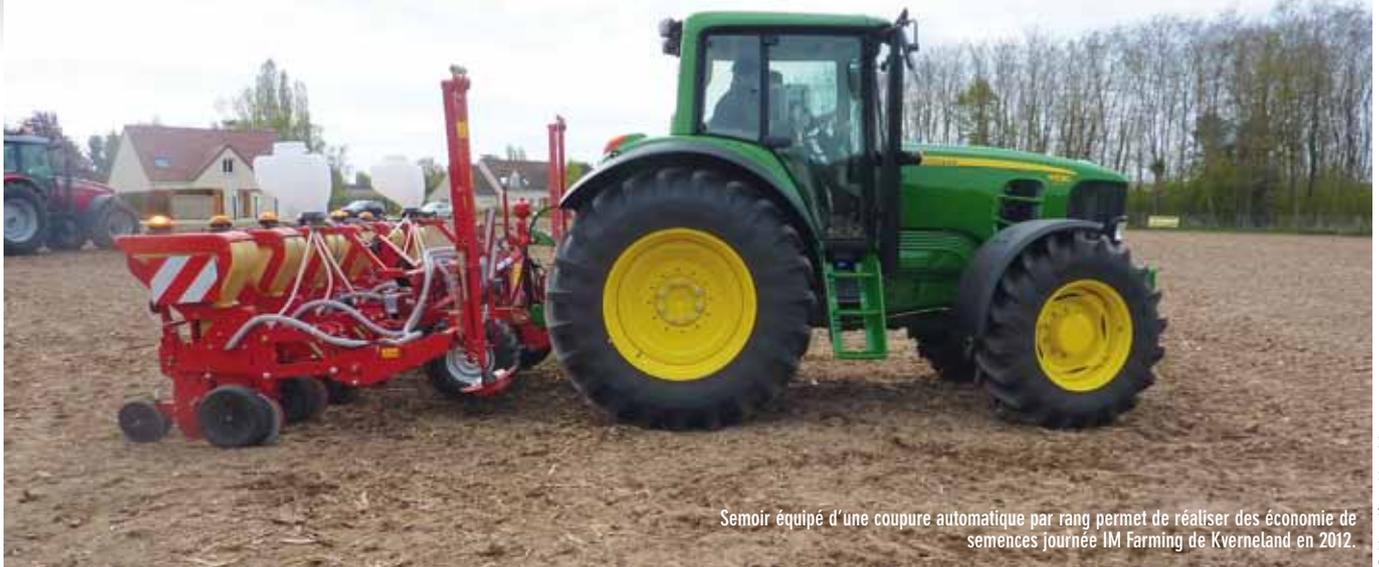
Semoir équipé d'une coupure automatique par rang permet de réaliser des économies de semences journée IM Farming de Kverneland en 2012.
