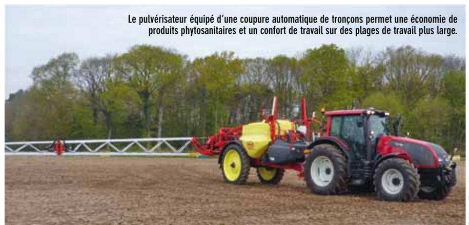
Le pulvérisateur équipé d'une coupure automatique de tronçons permet une économie de produits phytosanitaires et un confort de travail sur des plages de travail plus large.
