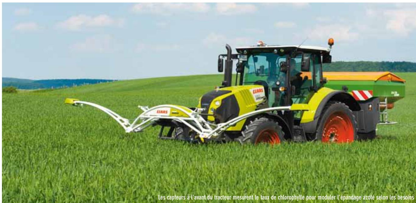
Les capteurs à l'avant du tracteur mesurent le taux de chlorophylle pour moduler l'épandage azoté selon les besoins
