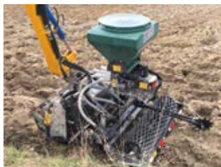
Le prototype de semoir de bords de champs est actuellement en phase de test
